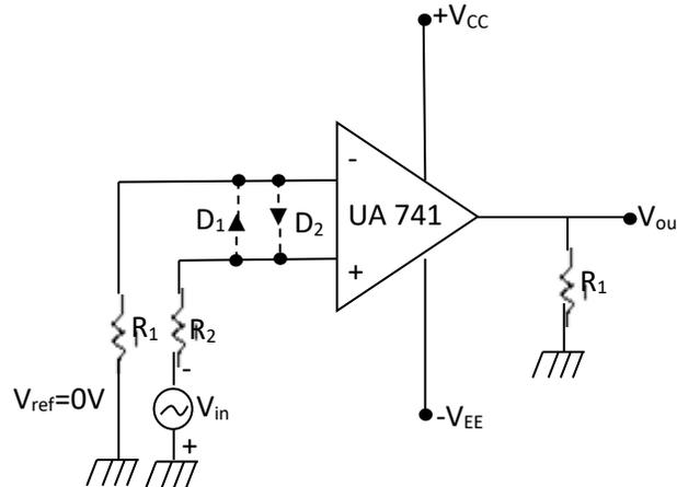
Figure 4.18 Zero Crossing Detector Using UA 741 op-amp IC
